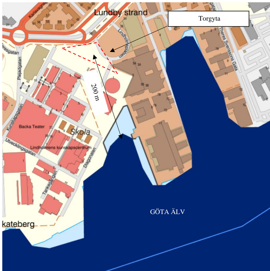
Figur 4. Avståndet till närmaste recipient är ca 200 m. Bedömd spridningsriktning för grundvatten är mot söder.
